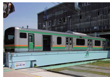
東日本旅客鉄道様向トラバースー トラバースー：平行移動装置 トラバースー製作スタッフ
