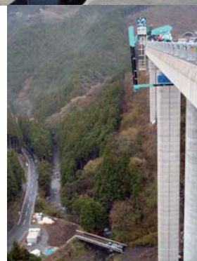
先端のゴンドラに乗る点検車
