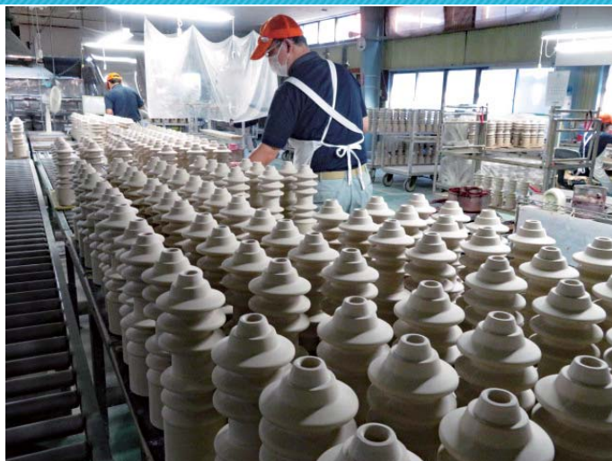
電柱に使われる配電用碍子
