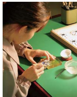
勲章製造（七宝釉薬手盛り）作業風景
