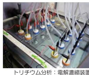
トリチウム分析: 電解濃縮装置
