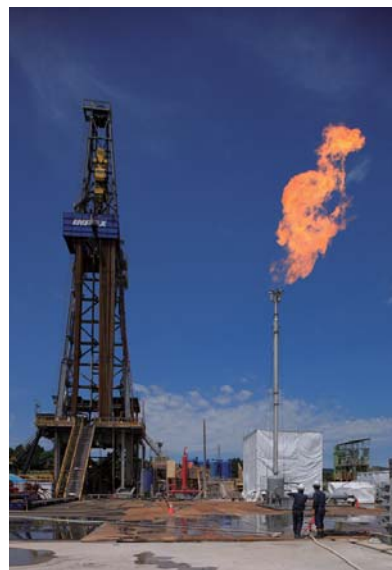
天然ガス噴出試験(試ガス)
